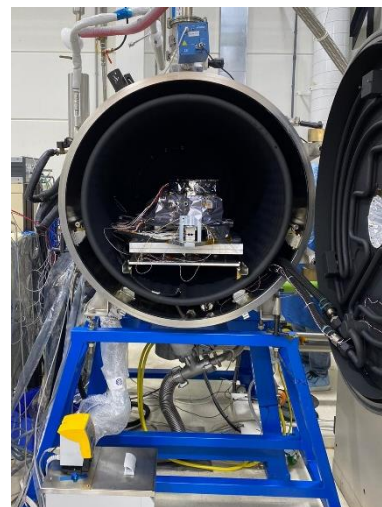
SPEXone wordt blootgesteld aan temperaturen tussen +60 en -30 graden Celsius - foto: Airbus DS NL
